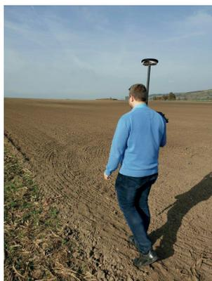
Abbildung 1: Mittels eines RTK-Messstabs wird die Bearbeitungsgrenze für ein Lenksystem erhoben.
